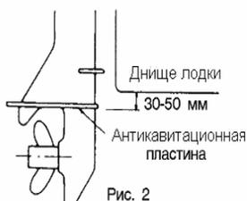
3. Прикрепить мотор к лодке, затянуть ручную винты. Для страховки привязать мотор верёвкой к лодке.
