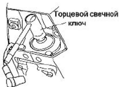
3. Вкрутить новую свечу по часовой стрелке с помощью штатного торцевого ключа.
